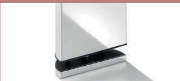
Über die Ausgleichsschraube am Fuß der Tischbeine lassen sich Bodenunebenheiten von bis zu 10 mm regulieren.
