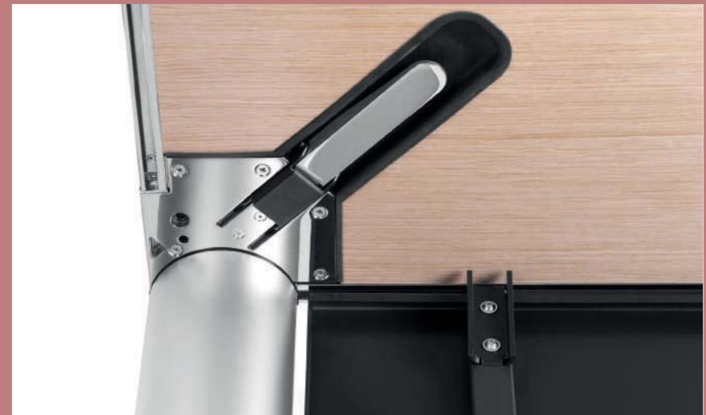
Oben: Das funktionale Kernstück von WINEA CONFERENCE. Die dreiteilige hochglanzverchromte Adoptionsplatte ist bündig in die Tischplatte eingelassen und umfasst neben einer Stahl-Flanschplatte mit geprägten Löchern zur Positionierung der Tischbeine auch die Grundplatte sowie die patentierte Spannhebel-Mechanik aus Zinkdruckguss.
