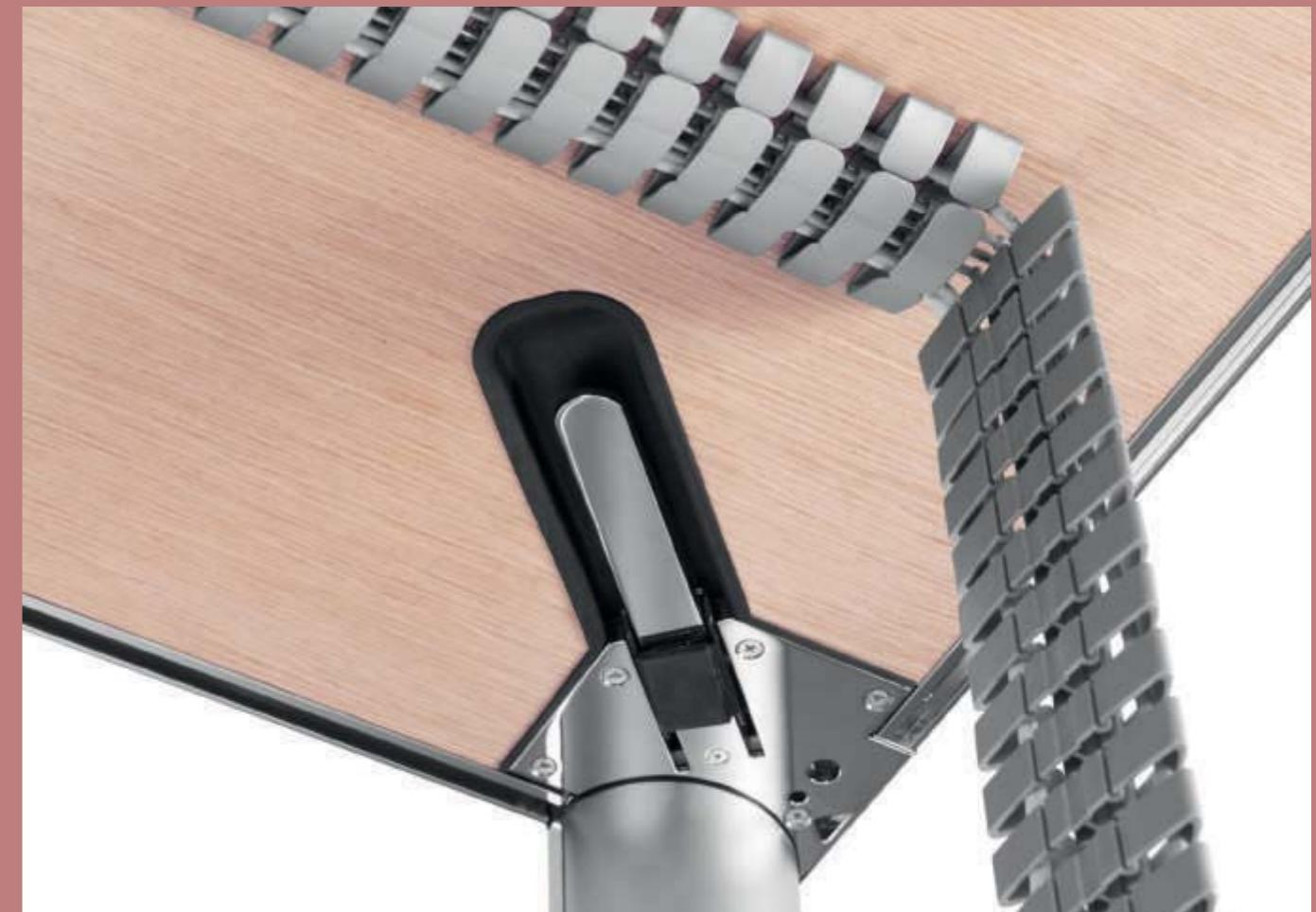
Die patentierte Spannhebel-Mechanik ermöglicht den schnellen, werkzeugfreien Auf- und Umbau von WINEA CONFERENCE: Zum Aufstecken der Tischbeine wird der Hebel gelöst und das Bein mit den Adoptionszapfen nach unten in die dafür vorgesehenen Löcher der Adoptionsplatte gesteckt. Durch Herunterdrücken des Hebels wird das Bein fest verspannt.
