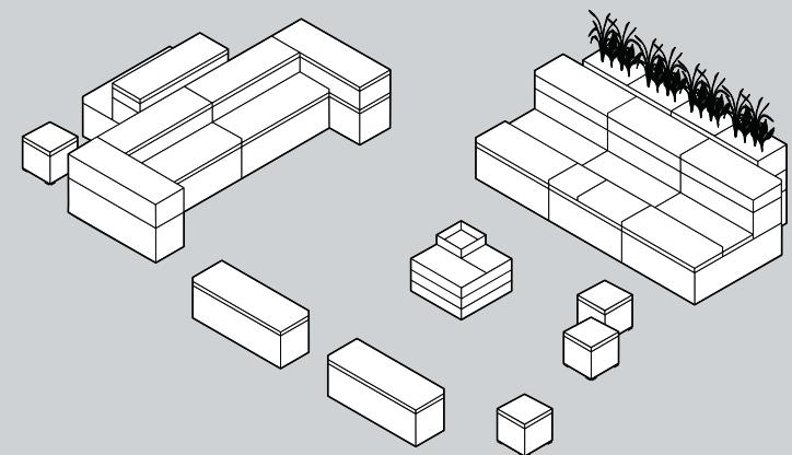
Das modulare System von WINEA ELEMENTS: Einzelemente in zwei Tiefen (400/800 mm), 7 Breiten (400 – 1.600 mm) und 3 Höhen (135/270/405 mm); Tribünenelement in 2 Tiefen (800/1.200 mm) und bis zu 5 Breiten (800 – 1.800 mm).
